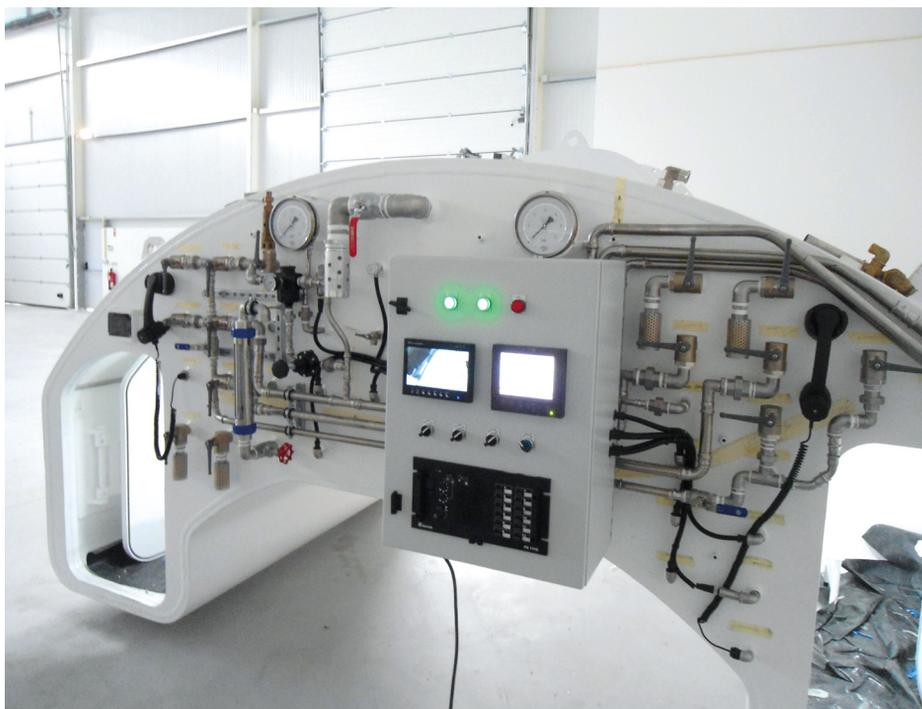
Figure 9 : Sas pour le Métro de Copenhague. Avant installation dans le TBM
