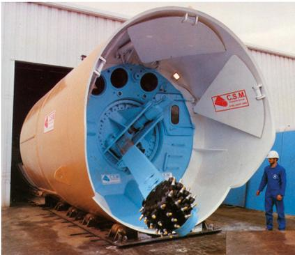
Figure 3 : Tunnelier type CSM BESSAC - Ø 4 m
